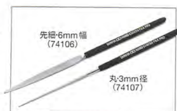
ハードコートヤスリPRO (先細・6mm幅 / 丸・3mm径) ハードクロムコーティングにより、一般的な精密ヤスリの3～6倍の耐久性と目詰まりの少なさを實現した小型精密ヤスリです。グリップ部は滑りにくく手になじむ特殊コーティング仕上げ。各3,520円(税込)
