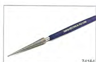
円すいヤスリ 切削部分を細長い円すい形としたダイヤモンドヤスリです。穴の開いたモールドの整形や、パイプ状パーツの縁を薄く削り込むのに最適。アルミや真ちゅうなどの軟金属も加工できます。1,980円(税込)
