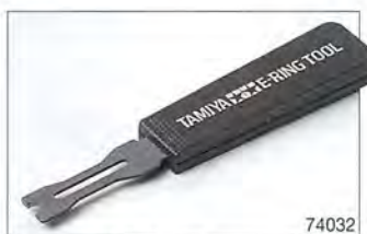
2mm Eリングセッター RCモデルによく使われる2mmEリングの取り付け、取り外しに便利。特殊形状のブレード先端にEリングをはめ込み、部品の溝に差し込むだけで簡単に取り付けできます。880円(税込)
