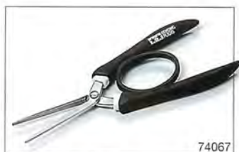
エッチングベンダー 繊細なエッチングパーツを正確に折り曲げられる専用ベンダーです。約45mmまでの折れ線なら一度で曲げることができ、小さなパーツは山形にカットされた先端を使うと便利です。3,080円(税込)
